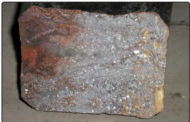
▲ Zikmundovo prasklé srdce - na lomu jsou vlevo nahoře jasně vidět zřetelné vady materiálu.
